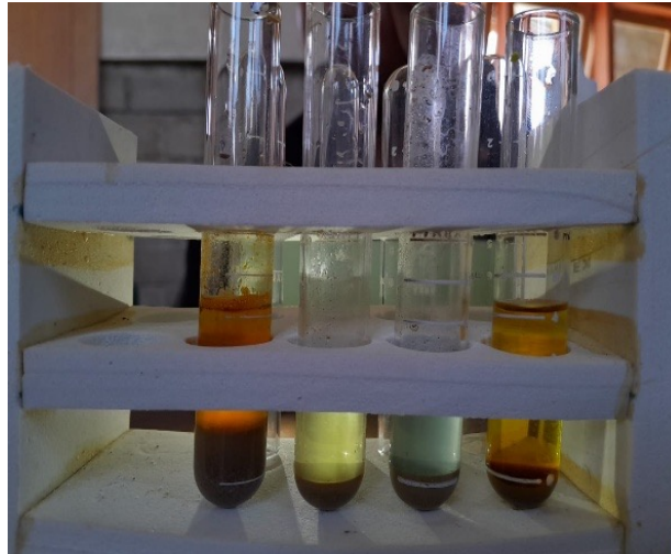
Gambar 4. Rangkaian warna indikator hasil ekstraksi hara dan pH tanah pada rak tabung reaksi.
