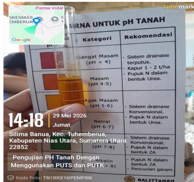
Gambar 2. Hasil pengukuran pH masam (4–5) menggunakan bagan warna indikator
