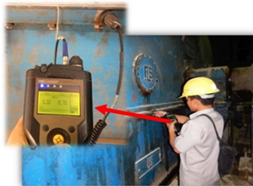
Gambar 1. Pengukuran nilai vibrasi pada cover Symetro Gear
